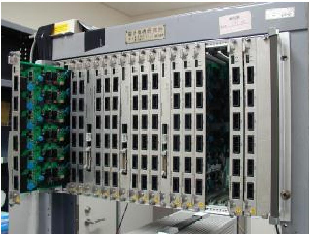
Fig. 18. 高電圧電源
