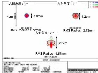
図 5.4: 両面フレネルレンズ1枚を用いたときの焦点面での結像の様子
