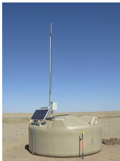
図 3.5 EASIER グループは GHz 帯のアンテナを Auger SD に取り付けている。
