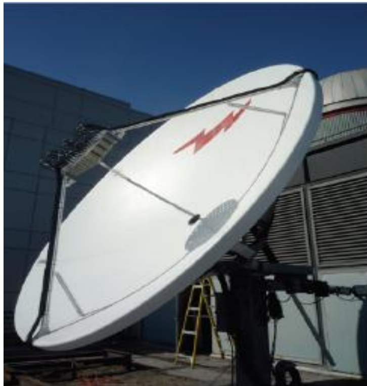
図 3.3 シカゴ大学の MIDAS グループの 4.5m パラボラアンテナに 53ch のカメラを取り付けている。
